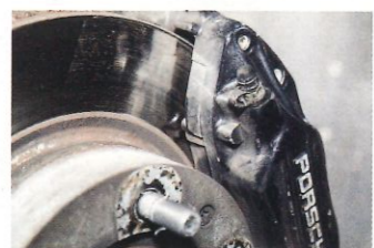
3 Comme les roues sont enlevées, profitez-en pour regarder le niveau d'usure des disques et des plaquettes.
