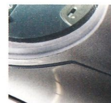
A La rouille s'installe généralement sur les baies de pare-brise.
