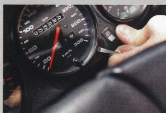
1 1 re étape, déloger délicatement le compteur à l'aide d'un tournevis plat.
