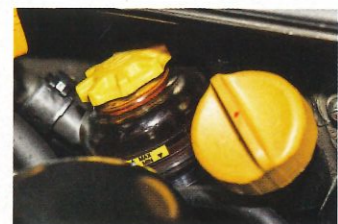
1 À droite du moteur, inspectez attentivement le niveau du liquide de la crémaillère de direction. S'il en manque cela signifie que la pièce est vraisemblablement à changer (1850€ en échange standard).
