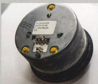
3 Pour repérer une éventuelle fraude, il faut inspecter le bloc arrière.
