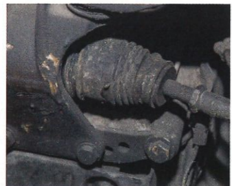
4 À l'avant, on a facilement accès aux soufflets de crémaillère de direction. Assurez qu'ils sont en parfait état et qu'il n'y ait aucune fuite.
