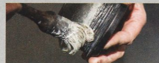
6 Enfin, avant de remettre le compteur en place, n'oubliez pas de le graisser pour qu'il rentre de nouveau dans son logement sans forcer.
